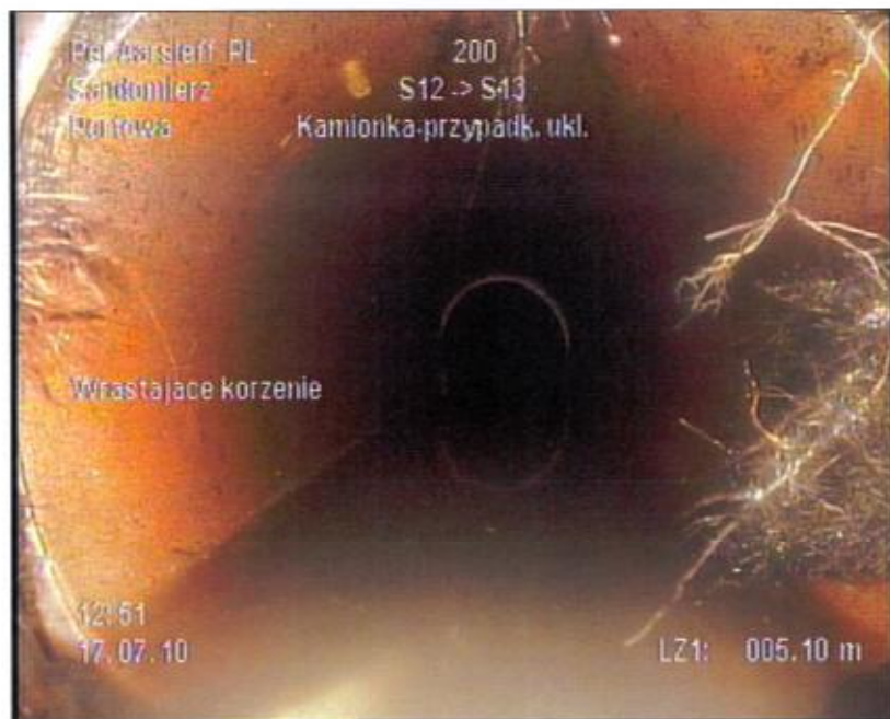
Zdjęcie: 11_3A 5,1m, Wrastające korzenie
